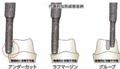
図9 CAD/CAM冠における形成での禁忌事項。「クラレノリタケ カタナアベンシアブロック」資料より改変引用
